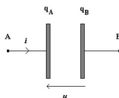
En convention récepteur, la flèche tension est orientée vers l'armature où arrive le courant.
